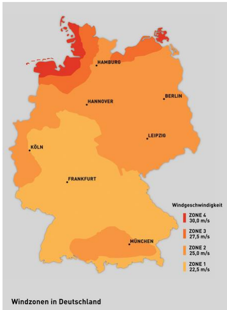
Abb. 25: Bereiche der Windzonen 1 bis 4 mit den zugehörigen Windgeschwindigkeiten (Quelle: Bundesamt für Bevölkerungsschutz und Katastrophenhilfe BBK)
